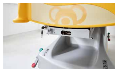
▲ Panel centralny znajduje się w zamkniętym na klucz schowku, umiejscowionym od strony nóg.
